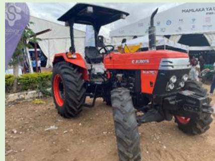
Name/Model: Tractor (Kubota)/EK4-751PRO (75HP/4WD)
